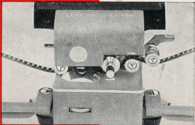
Aprire le braccia in posizione di lavoro. Fissare la bobina da visionare sul braccio sinistro (fig. 1).
