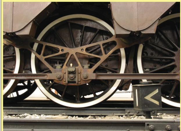
*Ursprünglicher dreieckiger Kando-Antrieb bei der Baureihe E.330.*
