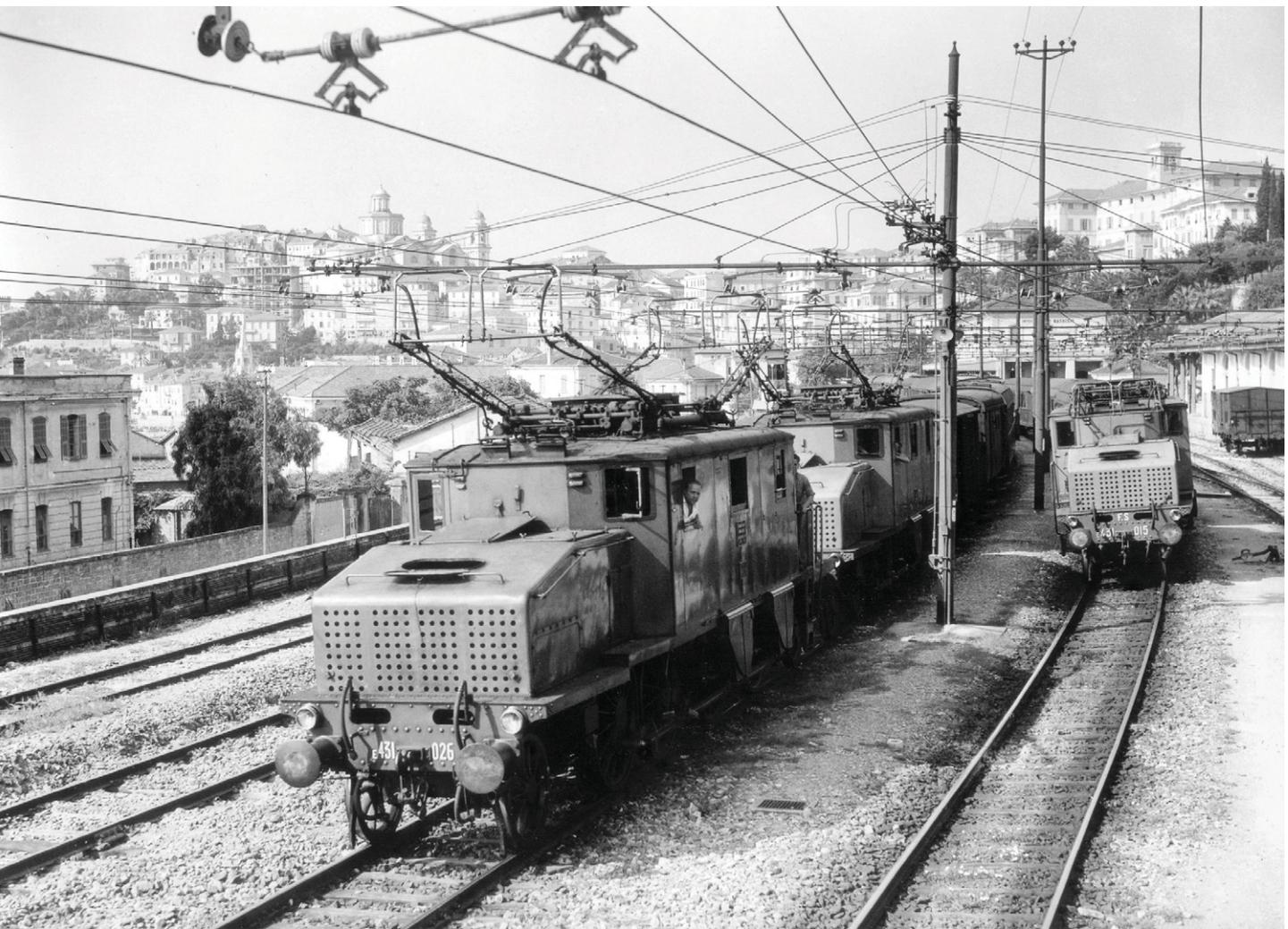
Die E.431.026 in Doppeltraktion mit der E.431.015 im Juni 1954 in Imperia Porto Maurizio. Die E.431.026 wurde als erste Lok dieser Reihe 1960 mit Mehrfachsteuerung ausgerüstet. (Dokument FS; Slg Franco Dell'Amico)
