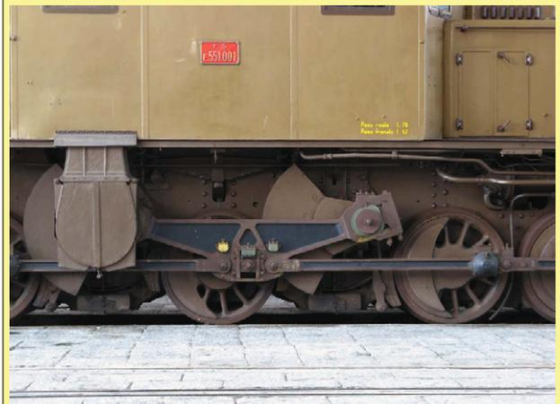
*Verbesserter Kando-Antrieb mit gelenkiger Kuppelstange bei der Baureihe E.551.*
