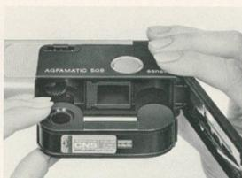
Filmkassette einlegen. Rückdeckel zuklappen und einrasten.
